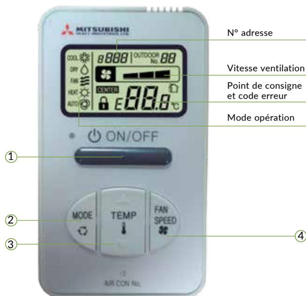
Conçue pour une utilisation en chambre d'hôtel, elle contrôle uniquement les fonctions : marche/arrêt, mode de fonctionnement, choix de température et vitesse de ventilation.
