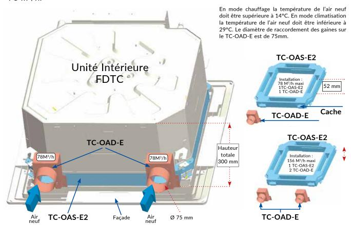
L'air neuf insufflé par l'intermédiaire de l'accessoire TC-OAS-E2 doit être pré-traité à l'aide d'un SAF-E6.
