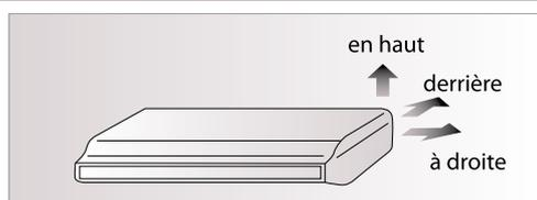
Les tuyauteries frigorifiques peuvent être dirigées vers 3 directions : (en haut, à droite, à l'arrière) pour un agencement parfaitement adapté à l'installation.
